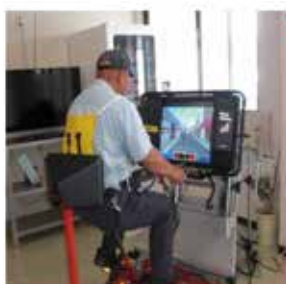
交通安全教室の例(「自転車シミュレーター」安全に自転車の危険場面を疑似体験できる教育機器)
