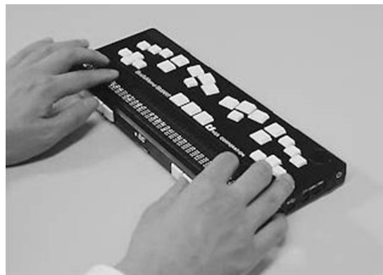
▲ブレイルメモ(点字で文章を作成、パソコンにも接続できる)
