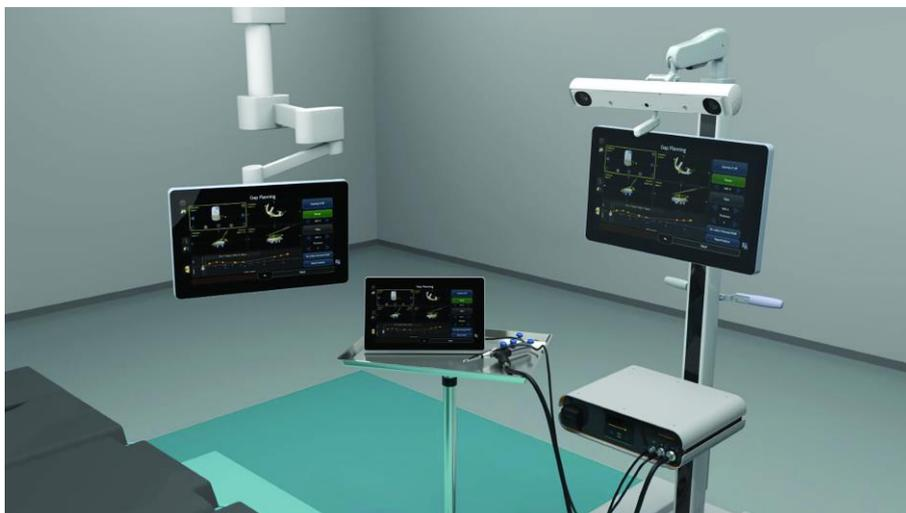
赤外線を発光する特殊なカメラを用い、大腿骨、脛骨にトラッカーと言われる赤外線光を反射する装置を設置し、トラッカーが位置計測の基準点となり、患者様の膝をコンピュータに位置登録することによって、3次元的な位置計測を行います。ロボット制御されたドリルを用いて、計画通りの骨切除を行います。骨切除を行う際には、ドリルの刃先の位置及び回転数を制御し、切除してはならないエリアでは切除出来ないようにロボット制御を行います。CORI《コリ》を使用することで、正確な骨切りができ、インプラントを計画通りの位置に設置することができます。
