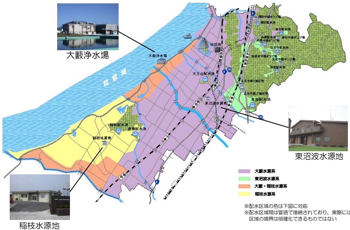
図 2-2 施設位置図および配水区域
