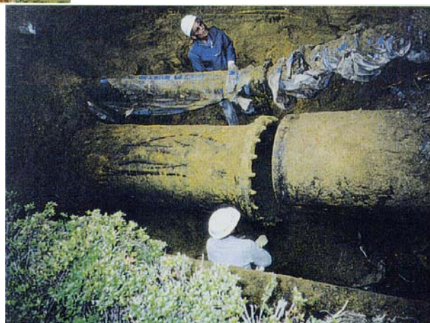
写真（右） ダクタイル鋳鉄管の継手離脱
