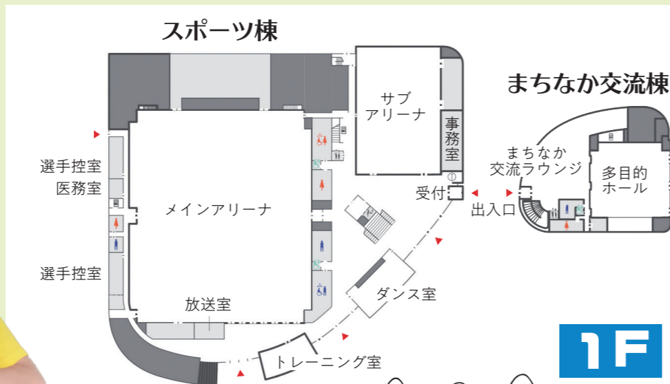
メインアリーナ ※「2025 国スポ」ハンドボール競技会場 ▶57m × 45m ▶固定席 1,546 席 / 可動席 1,176 席 / 車いす席 30 席 (計 2,752 席) ハンドボール 2 面、バスケットボール 3 面、バレーボール 4 面、バドミントン最大 15 面、フットサル 2 面
