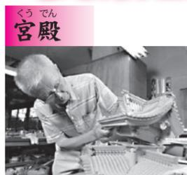
**宮殿** 円柱状の柱から、屋根の瓦に至るまでの小さな木片を膠付けしながら、屋根や柱を作ります。
