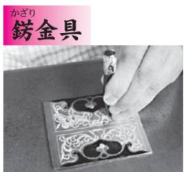
**銚金具** 多彩な技を駆使し、仏壇の装飾金具を作ります。金・銀・銅などを使って、手加工で彫金します。
