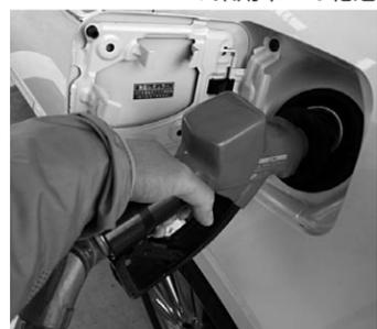
給油後は、給油キャップを確実に締める。
