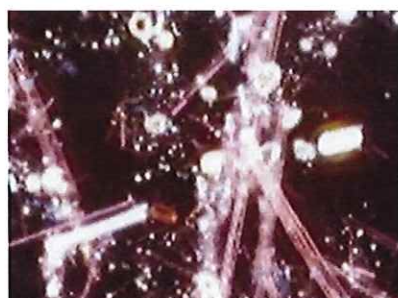
Amosite (屈折率 n_D^{25^\circ\text{C}} : 1.680 )
