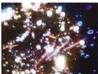
Crocidolite (屈折率 n_D^{25^\circ\text{C}} : 1.690 )
