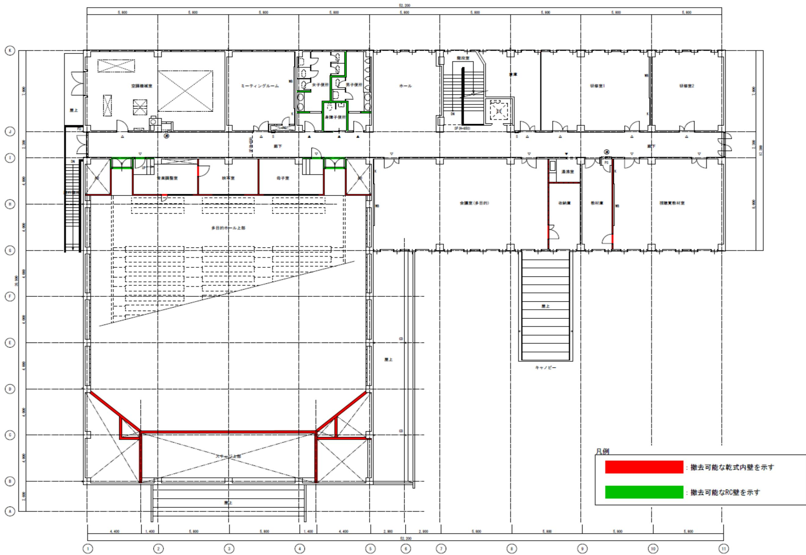
図 8 撤去可能な壁の図示(2階)
