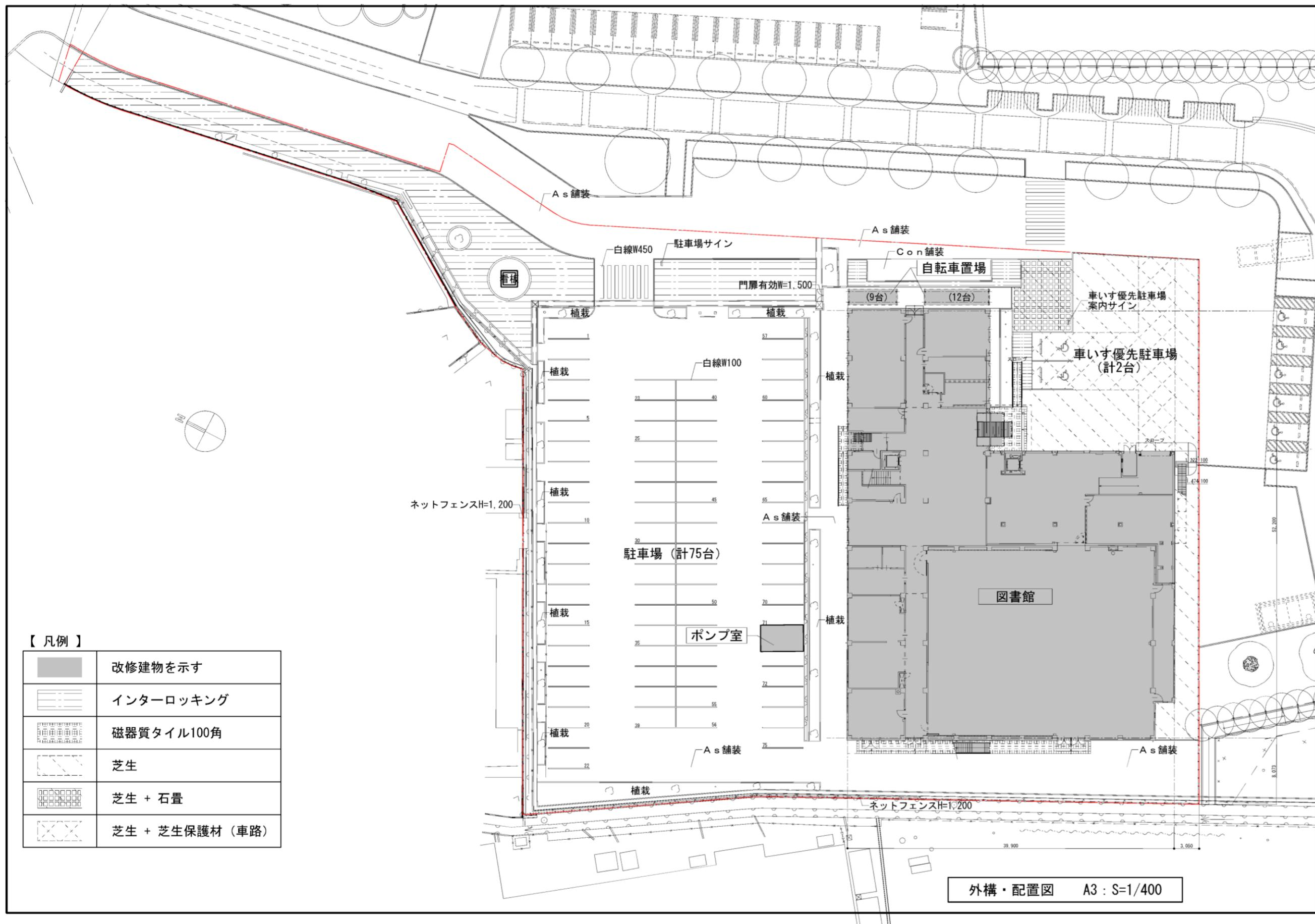
図 10 改修・増築整備配置図
