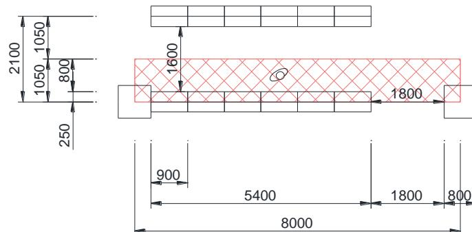
図 10 一般開架書架の計画寸法 (mm)
