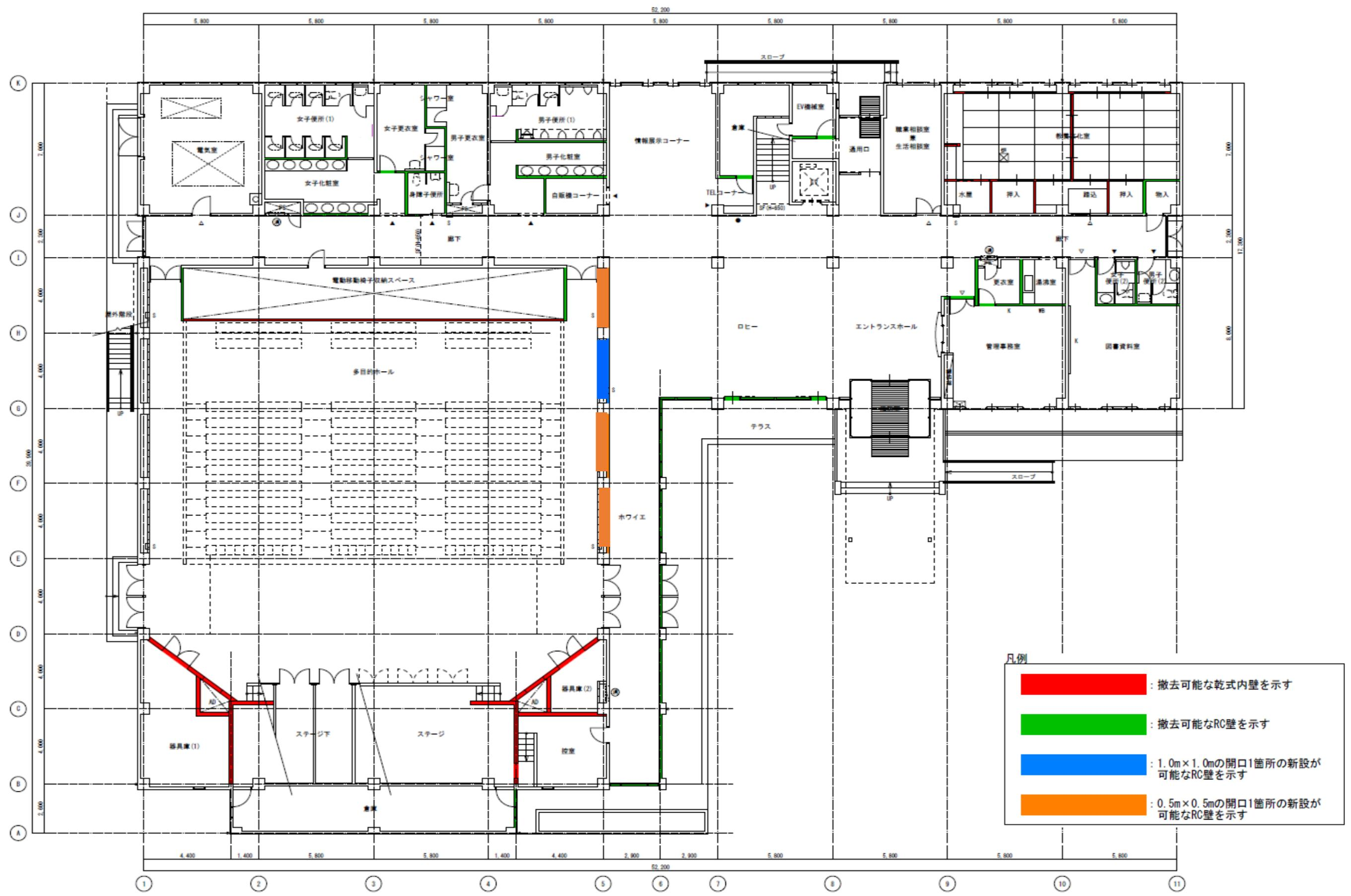
図 7 撤去可能な壁の図示(1階)
