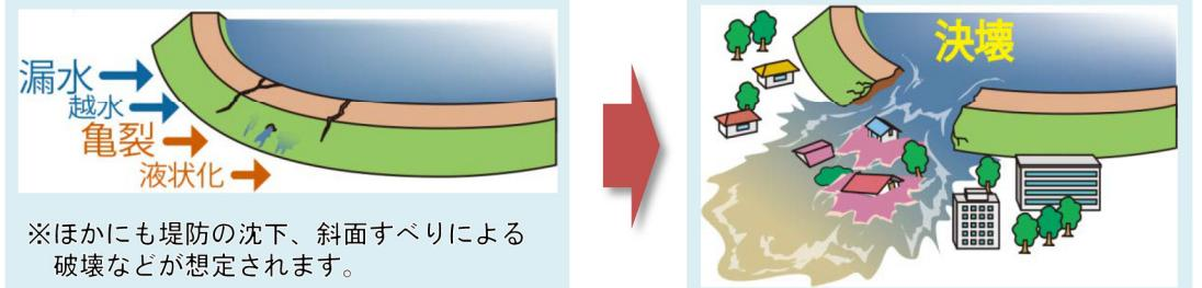
※ほかにも堤防の沈下、斜面すべりによる破壊などが想定されます。
