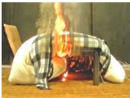
座いすとともに押し込まれた掛け布団から発火しました
