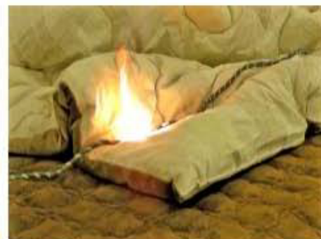
芯線が半断線状態となって短絡・スパークし、発火しました
